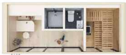
Модуль вид сверху (фасад из стеклопластика), 6 x 2,45 x 2,8 м RAL 1015 АН 013С
