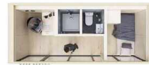
Модуль вид сверху (фасад из стеклопластика), 6 x 2,45 x 2,8 м RAL 1015 АН 007С
